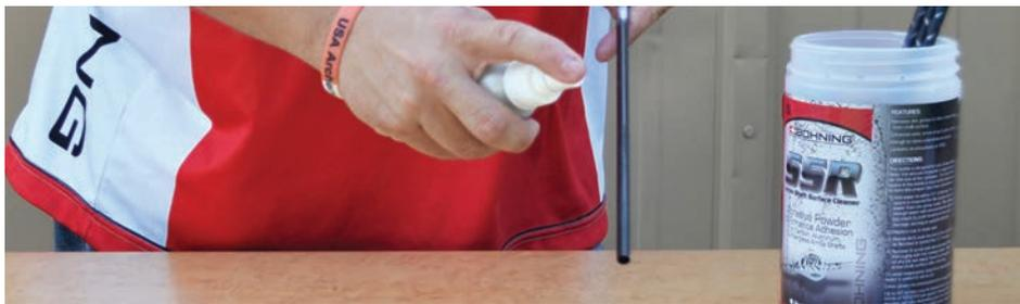
**Peinture:** Pour les tubes en carbone ou en aluminium, trempez la partie peinte du tube dans de l'acétone ou du diluant Fletch-Lac durant toute une nuit, puis frottez la peinture. Pour les tubes en bois, nous vous recommandons d'utiliser un décapant chimique spécialement conçu pour le bois.
